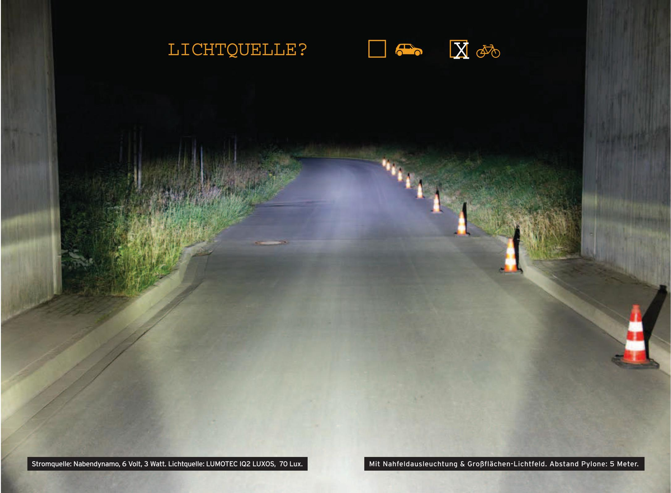
Stromquelle: Nabendynamo, 6 Volt, 3 Watt. Lichtquelle: LUMOTEC IQ2 LUXOS, 70 Lux.
